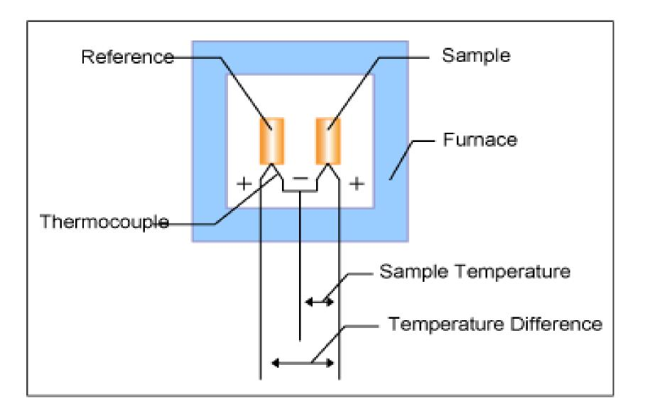
Fig. DTA INSTRUMENTATION
